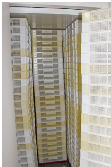
Die Nudeln werden in Körben bei 45 Grad Celsius je nach Sorte zwischen 24 und 40 Stunden in einem Raum getrocknet.
