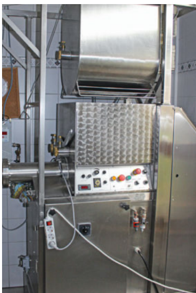
Das Herzstück der Nudelproduktion ist diese Anlage, in der Dinkelmehl mit Wasser vermengt wird.
